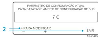
Se for exibido o ecrã “Modificar parâmetro de configuração para batatas” após premir a tecla de função SIM para selecionar um produto mencionado, o referido produto foi programado com uma determinada gama para o parâmetro de configuração. Complete os passos mencionados em seguida para selecionar o parâmetro de configuração do produto mencionado.
