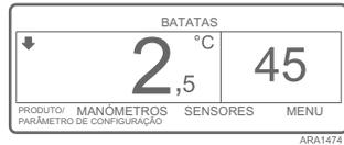
1. É exibido, por breves instantes, o ecrã “Modificar parâmetro de configuração para batatas”, seguido do ecrã “Parâmetro de configuração atual para batatas e gama do parâmetro de configuração é 40 a 50”.
